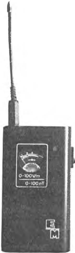
*Kombi-test com sonda para campos elétricos.*
