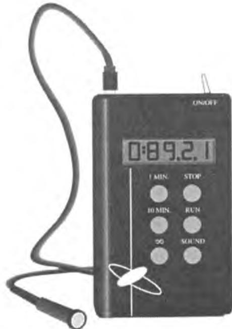
*O AIFAIX dispõe de um contador de janela final tipo G que é aproximadamente quatro vezes mais sensível que o tipo A, e é utilizado como tubo contador em laboratório.*
