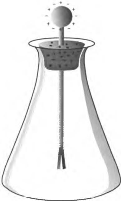
a) Eletrômetro descarregado, cargas positivas (+) e cargas negativas (-) iguais.
