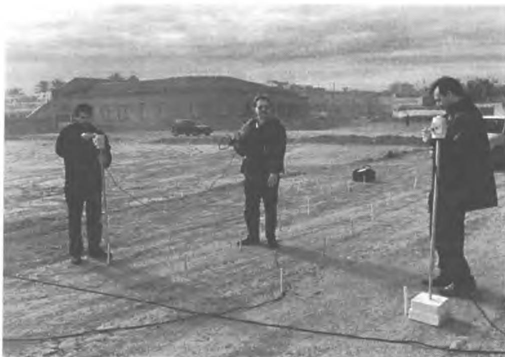
*Medições das variações de intensidade do campo magnético terrestre, realizadas com um magnetômetro de prótons e sistemas de sensibilidade pessoal. (Foto: José Mendoza)*
