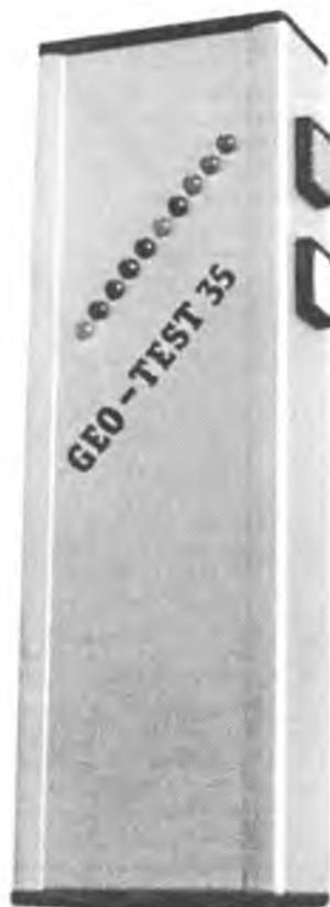
*Magnetômetro portátil "Geo-Test 35".*
