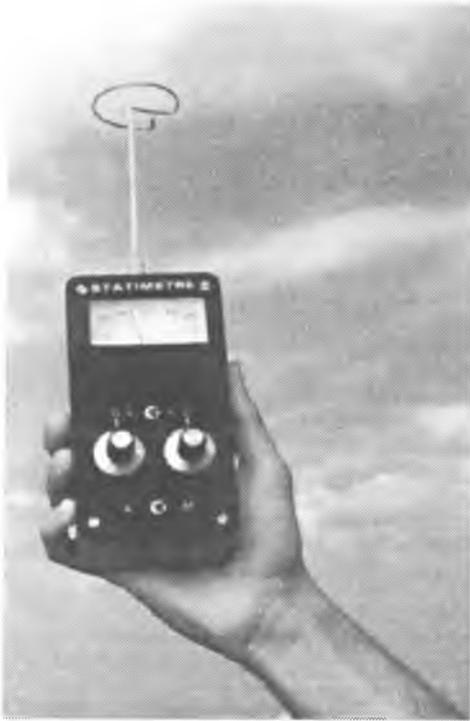
*Estatímetro que permite-nos ver o equilíbrio elétrico do ar.*
