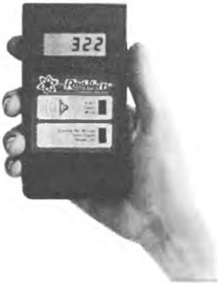
*ORADALERT é um medidor de radioatividade de fácil manuseio e versátil, pois pode ser utilizado como monitor de alarme (seu umbral é ajustável) ou para detectar gás radônio em uma casa. Graças a sua capacidade de detectar partículas alfa, também podemos comprovar se um alimento está contaminado.*
