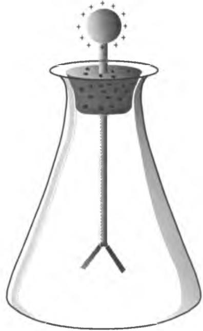
b) Eletrômetro saturado de cargas positivas (+). Reagem separando as lâminas de ouro.
